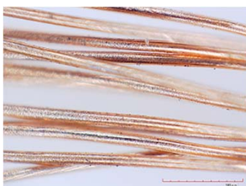
図 4.3 #6 裸線 SS 撚りの試験後導体側面観察（200 倍）
