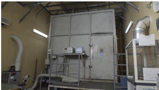
図5 3 mキューブ試験室外観
