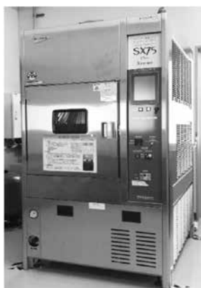
図4. 昨年度導入した2号機スーパーキセノン 促進耐候性試験機
