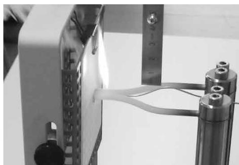
図2 グローワイヤ試験装置(グローワイヤの押付け)
