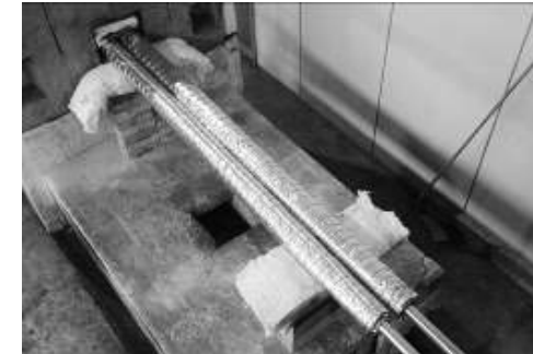
写真2. 試験体の加熱炉設置状況
