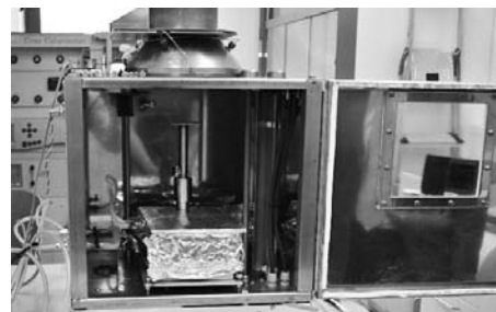
写真4 ISO/NP5660-5用試料加熱チャンバの内部
