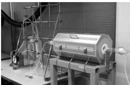
図1 試料燃焼装置(管状炉)とガス回収装置
