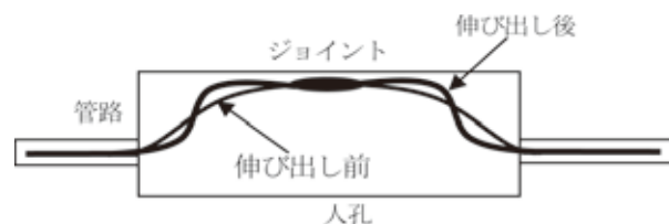
図3 人孔内オフセット（ジョイント固定）
