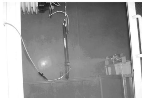
写真2 耐トラッキング試験状況
