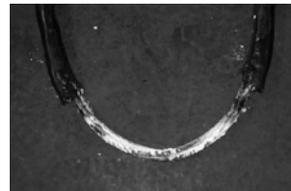
図1 IEC60331-31試験後試料
