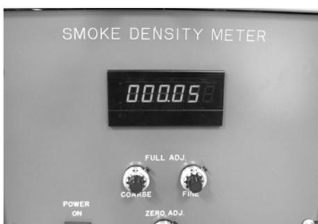
図4 試験機チャンバー内の光透過率表示部
