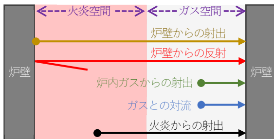
図10 炉内熱伝達(放射と対流)の模式図
