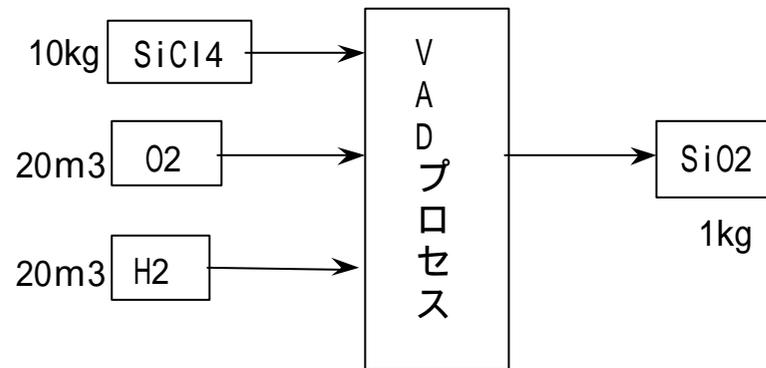
資料3.(2)-18光ファイバ用SiO<sub>2</sub>の製造工程
