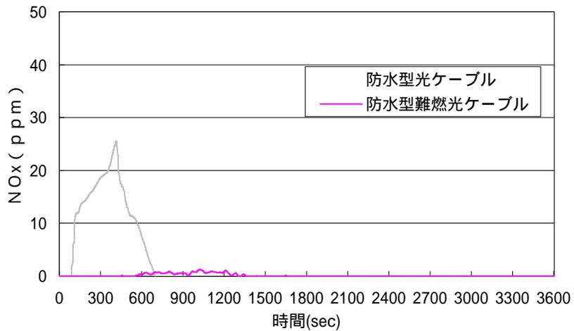
図2.(3)-20 防水型光ケーブルと防水型難燃光ケーブルのNOx発生量
